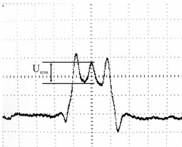
Рис. Г4 - Реальные эпюры напряжения от телекамеры в точке 1 (см. Рис. Г3)
