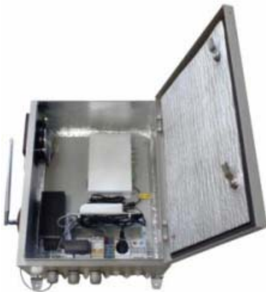
Рис. 8 - Удаленный IP-видеосервер в термокожухе с возможностью взаимодействия через WiFi канал.
