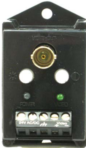
Рис. Н7 - Внешний вид активного приемника по «витой паре» (вид сверху)
