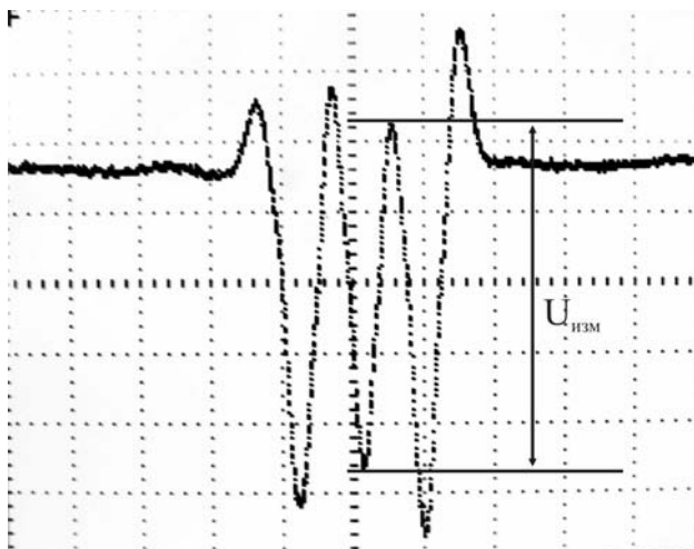
Рис. Г9 - Реальные эпюры напряжения от телекамеры в точке 6. (см. Рис. Г3)
