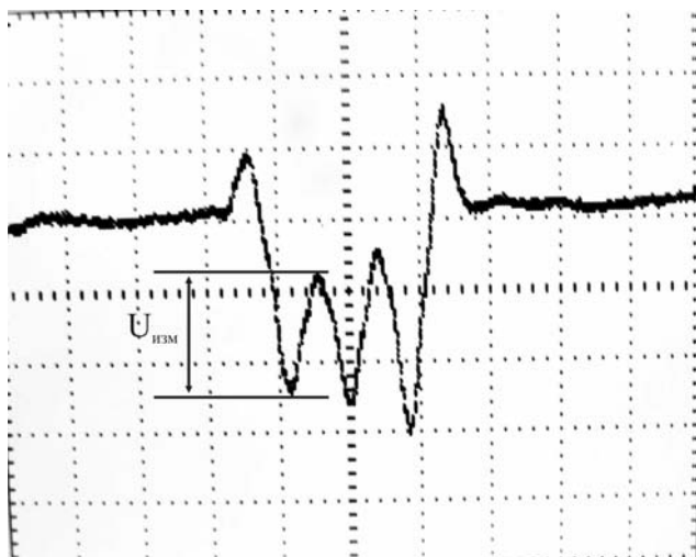
Рис. Г11 - Реальные эпюры напряжения от телекамеры в точке 8 (см. Рис. Г3)
