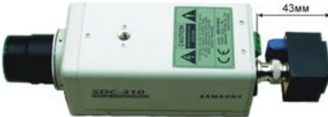
Рис. Н2 - Малогабаритный видеопередатчик (габаритный размер не превышает 43мм)
