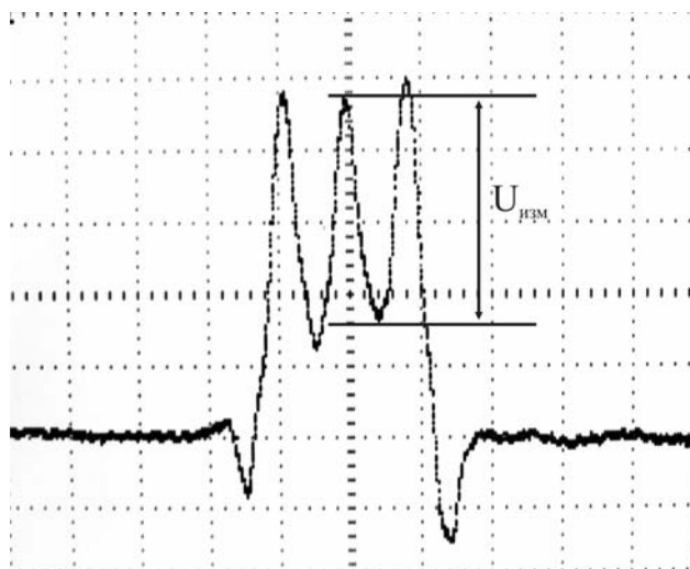
Рис. Г6 - Реальные эпюры напряжения от телекамеры в точке 3 (см. Рис. Г3)
