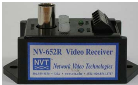
Рис. Н6 - Внешний вид активного приемника по «витой паре». Видны два подстроечных резистора: регулировка яркости (амплитуды сигнала), регулировка четкости (коррекции АЧХ)
