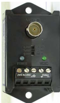
Рис. Н5 - Внешний вид активного передатчика по «витой паре» (вид сверху) В центре виден переключатель длины линии 500 м, 1000 м, 1600 м
